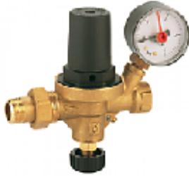
El uso de esta válvula de llenado automático se hace prácticamente imprescindible para conseguir mantener la integridad de la instalación en previsión de posibles pérdidas de agua por purgados, descargas de la válvula de seguridad u operaciones de mantenimiento. Permite mantener siempre el circuito hidráulico lleno de agua a la presión de servicio que se desee, permitiendo además cortar fácilmente la alimentación de agua de red al circuito.
