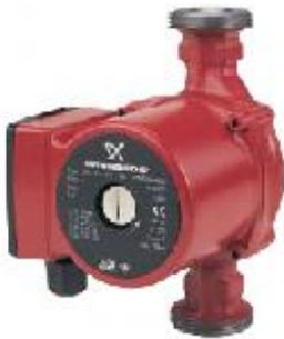
La función es hacer circular el agua del circuito a los radiadores o suelo radiante, la bomba se hace funcionar mediante un termostato de contacto y va conectada a la red eléctrica. La bomba se puede conectar a la ida y al retorno ya que funcionara en los dos sitios, pero es muy recomendable ponerla al retorno con el fin de no castigarla innecesariamente con temperaturas tan altas como en la ida, y con esto alargar la vida útil de la bomba.
