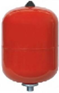
Los vasos de expansión funcionan al aumentar la temperatura del líquido caloportador también aumenta su presión y el líquido se expande en el vaso desplazando la membrana elástica hacia la parte inferior, disminuyendo así el volumen ocupado por el gas.
