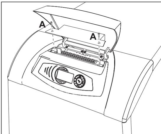
fig. 25 - Acceso a la regleta de conexiones
