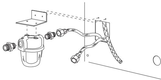
fig. 20 - Instalación del filtro del combustible
