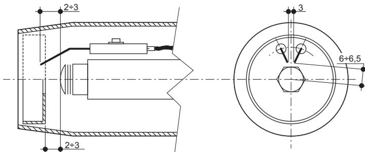
fig. 32- Posición de los electrodos y del deflector
